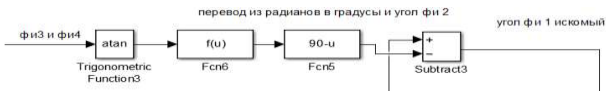
Рис. 5. Структурная схема вычисления угла поворота судна \angle\varphi_1
